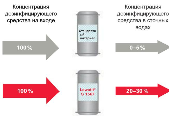
Рисунок 2: Использование дезинфицирующего средства для ионообменной смолы
